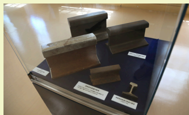
津軽森林鉄道使用のレールと新幹線のレールとの比較展示
