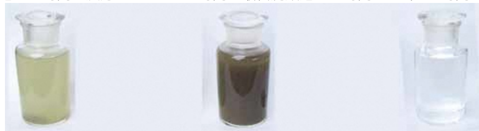
最初沈殿池 反応タンク 最終沈殿池
