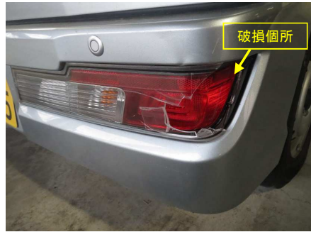
青森市側破損箇所
