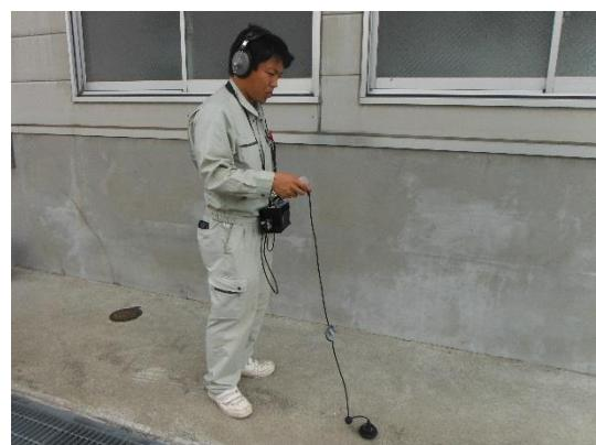
漏水探知機による漏水調査
