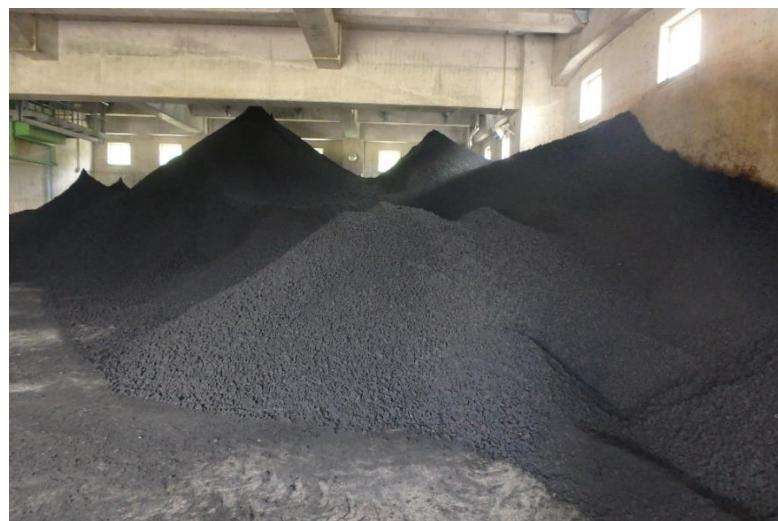
堤川浄水場 脱水後の浄水発生土
