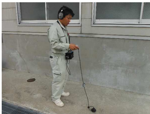
漏水探知機による漏水調査
