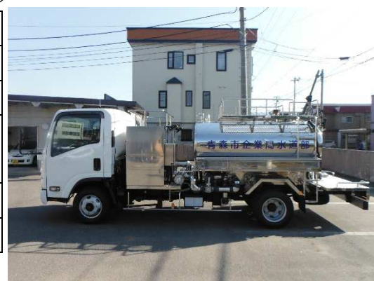
タンクローリー型給水車
