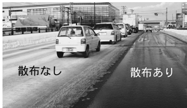
〈ホタテ貝殻を活用した凍結防止剤の散布で融雪した車道 (新妙見橋)〉
