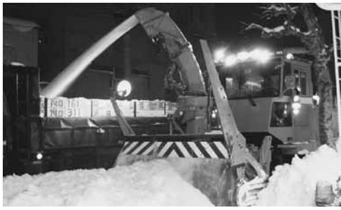
〈除排雪作業の効率性の観点から、2トン車ダンプトラックにも差し枠の使用の検討が求められている(写真は、差し枠を使用して排雪作業をしているダンプトラック)〉
