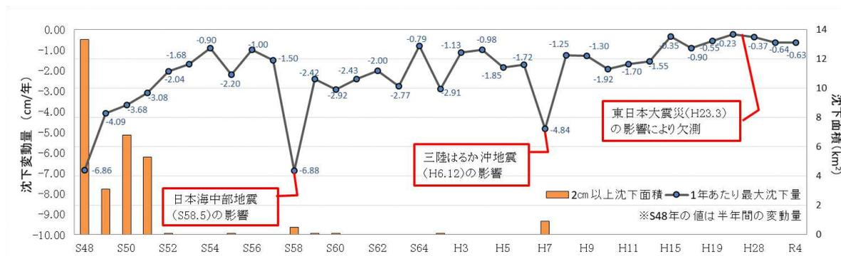
図 3-51 地盤沈下観測水準測量(最大沈下量経年変化)
