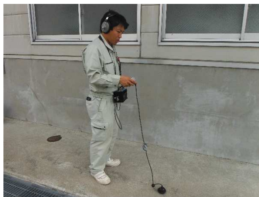
漏水探知機による漏水調査
