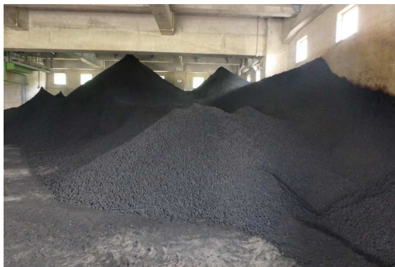
堤川浄水場 脱水後の浄水発生土
